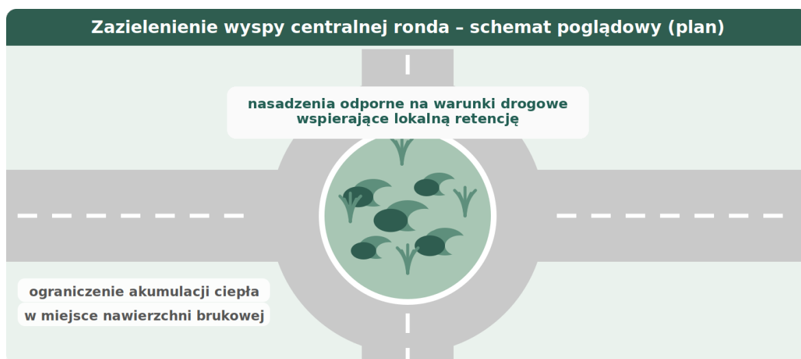
Rysunek 5. Zazielenienie wyspy centralnej ronda – schemat poglądowy
